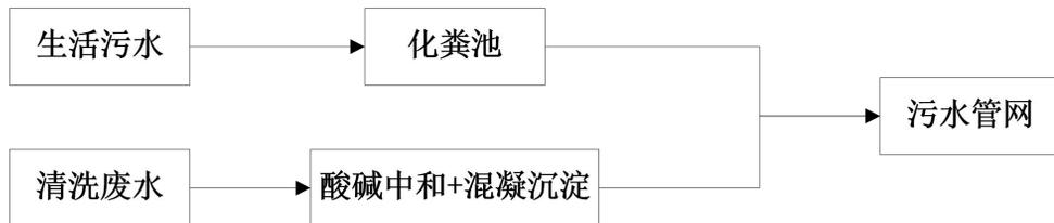
图4-1 废水处理设施处理流程图
